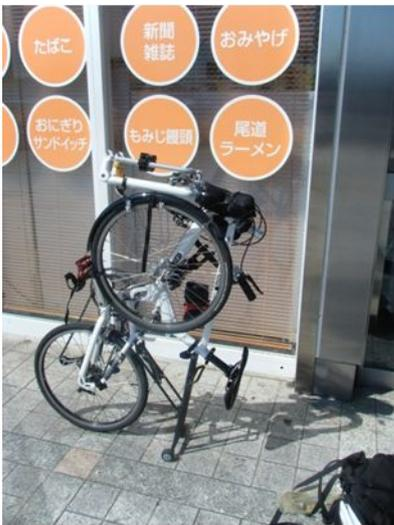
メーカーさんも提唱している直立フォールド。床面積が小さいまま上方向に伸びて行きます。メーカーさんは自宅などで収納するとき、、、、ということでしたが、南風方式では、この状態で電車に持ち込んでみました。床面積が小さいのに上方向に伸びていきますので、実は混みあった電車などでは有効だと考えております。後輪、そしてキャスターの3点支持で、このまま前方向に進む事が可能ですので、輸送する際に持ち上げることなく押して移動可能なんです。
